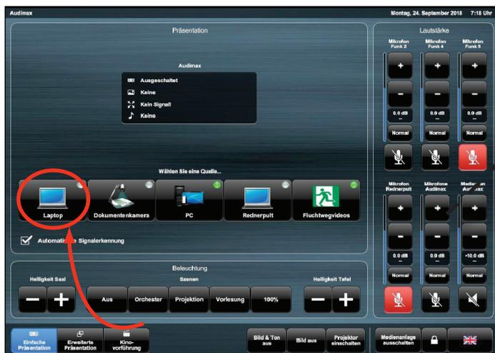
Sobald das System gestartet ist und der Hörsaal bereit ist, sehen Sie nebenstehenden Bildschirm. Um Ihr Laptop-Bild auf den Beamer zu schicken, müssen Sie den Punkt „Laptop“ anwählen. Der Beamer startet automatisch, sobald eine Quelle (HDMI/VGA/Displayport) anliegt
